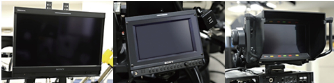
フロアモニターにPVM-2541(写真・左)、クレーンカメラのモニターとしてPVM-740(写真・中央)、7.4型有機ELカラービューファインダーHDVF-EL75(写真・右)も運用中。
