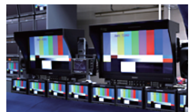
VE卓のマスターモニターに採用されたBVM-F250。薄型・軽量を生かし、回転機構付きのスライド棚に設置することでより視認性を向上。
