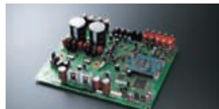
■メイン基板は音の入出力コネクターを一切使わず音質劣化を抑えました
