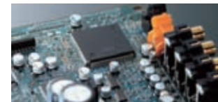
■高精度アナログ変換を可能にするスーパーオーディオD/Aコンバーター基板
