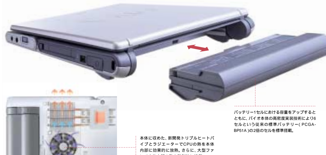
「サーモダイナミクスエアダクト」による放熱・排気イメージ
