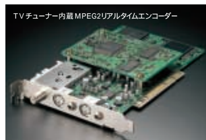
写真上部の基板はDVアナログ変換ハードウェアです。PCV-RX52シリーズには装備いたしません。
