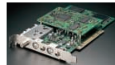
写真上部の基板はDV → アナログ変換ハードウェアです。PCV-RX55シリーズには装備いたしません。
