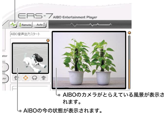
接続したばかりのAIBOはリモートモードで、あなたの操作を待ちます。
