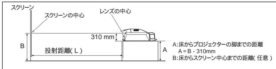
投射距離は、入力信号の種類や投影画像のサイズによって異なります。該当する投射距離表で、最適なスクリーンの横幅( W )から投射距離( L )を決定してください。
