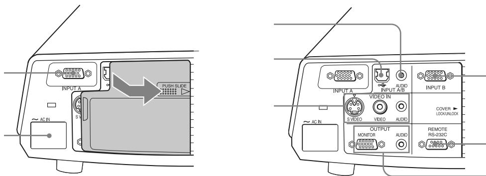
入力B端子やビデオ端子を使用する場合は、カバーを開く。カバーを押して、右へロックされるまでスライドさせる。カバーを閉じるときは、カバーを押すとロックがはずれるので左へスライドさせる。
