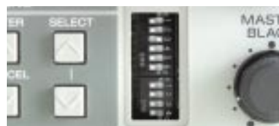
CCU-D50のリモートコントロールモード設定スイッチ。初期設定はM5Aモード。
