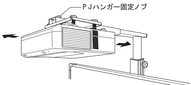
プロジェクターにデジタル補正や台形補正などを設定している場合は、すべて初期化して補正されていない状態にしてください。
