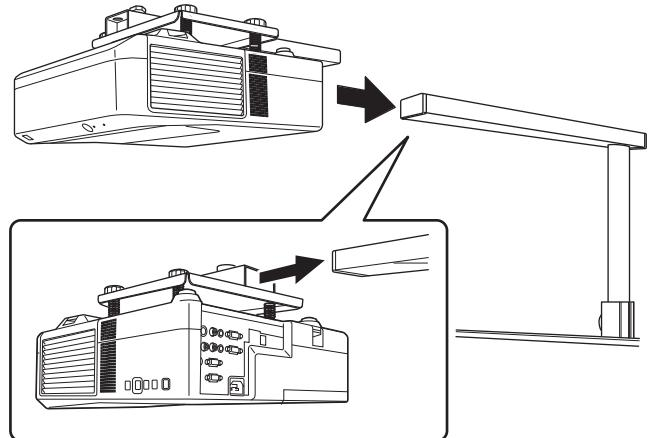
2. PJアームの3つのネジ穴のうち、手前側の2つのネジ穴をスリットに合わせ、PJハンガーフィットを差し込んで締めます。
