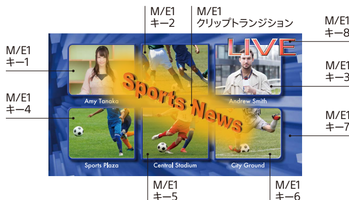
M/E1 出力映像例 (HD) : 8 キーヤー＋クリップトランジション
