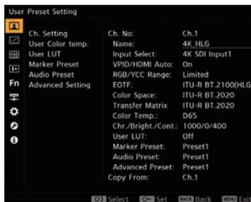
入力や表示切り替えは、チャンネル(CH)切り替え方式を採用。前面コントロールパネルのCH SELECTから、予め設定した30CHを呼び出せます。ファンクションボタンに指定CHを割り当てることで、CHに紐づけられた異なるマーカーやユーザーLUTを即座に切り替えることができます。
