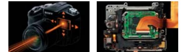
カメラの揺れによるブレを打ち消すようにCCD手ブレ補正ユニットが作動する、
