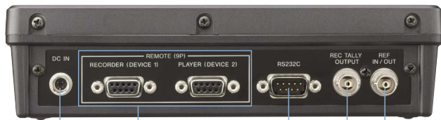
DC IN 12 ~ 15V REMOTE (9P) RS-232C (メンテナンス用) REC TALLY 出力 REF IN/OUT
