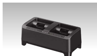
バッテリーチャージャー BC-DWX1 希望小売価格 34,000円+税 2台同時に充電可能なDWT-B03R・NP-BX1専用充電器 ・AC電源アダプター AC-UES1230MT(別売)とLANケーブルで電源供給するPoEの2ウェイ電源方式 ・ネットワーク接続することで、PCソフトウェア Wireless Studioから充電状態の監視、設定の変更が可能 ・充電電池の長期保存のためのストレージ充電モードを搭載
