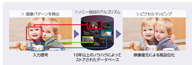
データベース型超解像処理LSI（リアリティクリエーション）の仕組み
