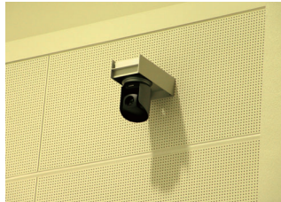
アリーナ4隅の壁面に設置されたBRC-H700。プロジェクターを使って200インチスクリーンにハイビジョン表示することも可能。また、最大12台まで拡張できるように配線されています
