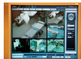
カメラ映像を選択すると、拡大表示が可能。操作はリモートコントローラーRM-NS10で行う。
