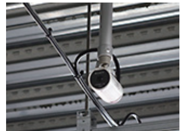
PoEに対応したモデルで、ケーブル1本の設置を実現
