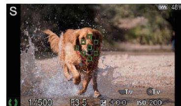
モニター全体を基準に、自動ピント合わせをします。静止画撮影でシャッターボタンを半押ししたときには、ピントが合ったエリアに緑色の枠が表示されます。
