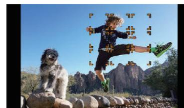
モニター上でピントを合わせたいゾーン的位置を選べます。選択した位置には、グレーの枠が表示されます。ゾーンは9個のフォーカスエリアに分かれており、その中でピントを合わせるエリアが自動的に決定されます。
