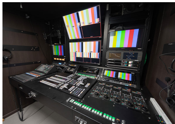
中継車内卓上センターに『XVS-G1』のパネル。 SW・VE 兼務を想定したレイアウトが特徴
