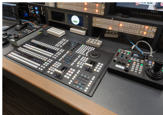
サブ卓上の『XVS-G1』と両サイドのカメラのリモートコントロールパネル
