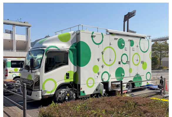
『XVS-G1』と『HDC-3200』を搭載した多系統対応の中継車
