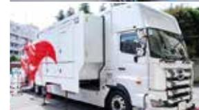
右側はモニター部分が0.8m拡幅する
