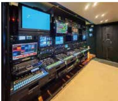
拡幅構造により、広大なスペースを得た制作エリアとVEエリア
