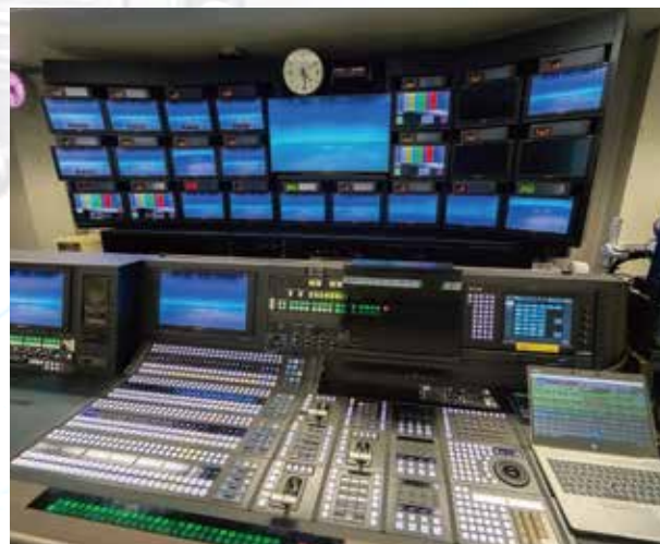
HDRフォーマット変更ボタンを備えたスイッチャー卓とメインモニター棚
