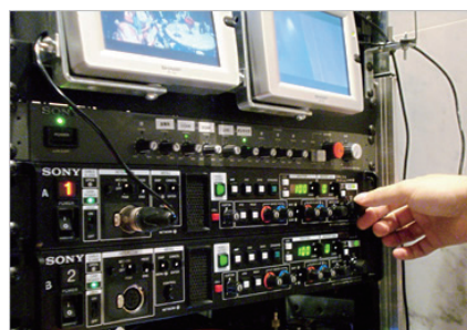
小型ラックに収納されたCCUからカメラをコントロール
