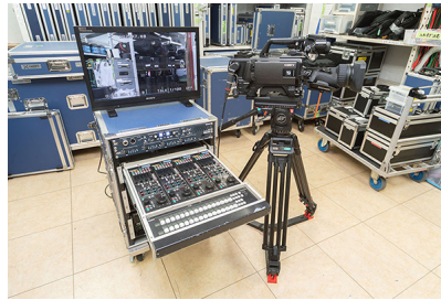
ハーフラックサイズの CCU 4 式を 1 セットとして構築された可搬型ラック
