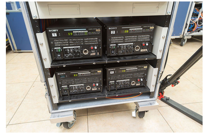
ハーフラックサイズの CCU 4 式を 1 セットとして構築された可搬型ラック
