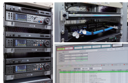
送出サーバーとしてXDCAM Station XDS-PD1000（写真・左）を採用した番組自動送出システムSWEV-N100A（写真・右上）でXDCAMフォーマット(MPEG HD 35Mbps)による効率的なファイルベース運用を実現。電子番組表(EPG)の自動生成を活用することで効率的な番組送出を実現しています（写真・右下）。
