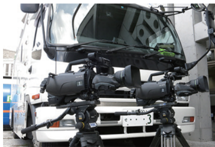
HDC-4300とBPU-4000を2式導入。HD中型中継車に搭載のカメラコントロールユニットHDCU-2500と接続することでバスケットボール、ゴルフ、野球、サッカーなどのライブ撮影に本格運用中です。
