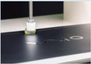
■ 液晶加圧試験 液晶に直接力が加えられても壊れにくい構造を追求
