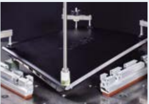
■ 本体ひねり試験 突然の強いひねりからデータを守る堅牢性を追求
