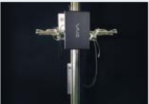
■ 90cm (6面) 落下試験 持ち運び時の落下に対する堅牢性を追求
