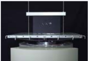
■ 振動試験 梱包状態での振動試験で、輸送時などの堅牢性を追求
