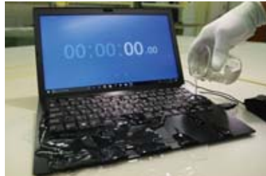
キーボード水かけ試験 (VAIO Pro PJ / PK / PA / PG で実施)
