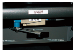
扉の開閉とシステムの電源を連動させ、切り忘れを防止する。
