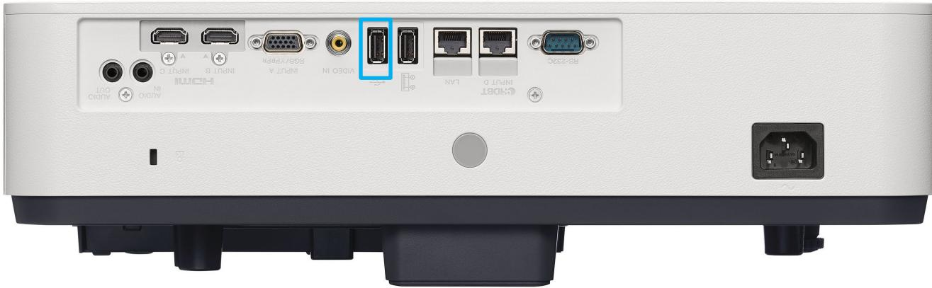
5. プロジェクターの Input ボタンを押しながら、電源コードを接続してください。ON/STANDBY のインジケーターがオレンジ色の点滅を始めるまで Input ボタンを離さないでください。ON/STANDBY のインジケーターがオレンジ色で点滅すると、アップデートが開始されたことになります。
