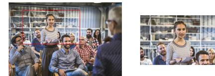
ジェスチャー認識技術により人物が起立したシーンを検知し、それをトリガーとして人物のズーム映像を自動で生成するアプリケーションです。1台のカメラで全体の俯瞰映像と起立した人物のクローズアップ映像を得ることができます。
