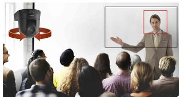
話者の動きに合わせて、PTZカメラを自動で回転させるアプリケーションです。まるでオペレーターがマニュアルで操作しているかのような細やかなカメラ操作を自動で行えます。
